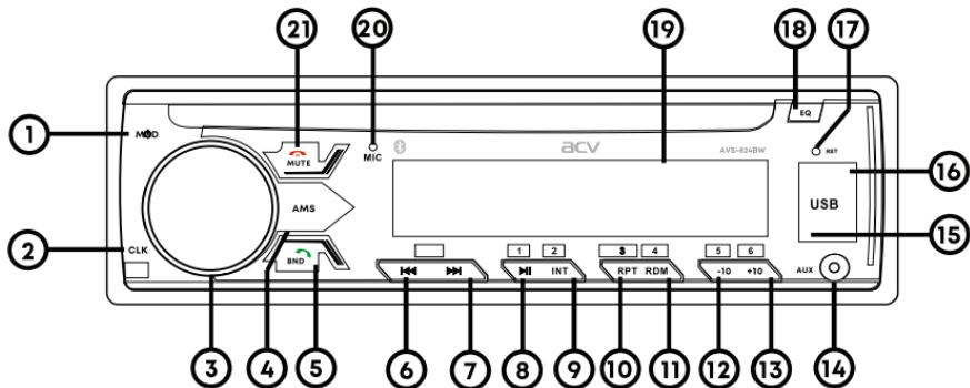
1. **МОД** - кнопка включения/выключения устройства, выбора режимов ресивера.
