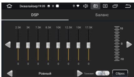
Экран настройки **DSP** предоставляет доступ к цифровому 18/12-ти полосному эквалайзером с семью предустановленными режимами: Ровный, Джаз, Классика, Рок, Поп, Стандартный, Свой (предустановка, сохраненная пользователем).
