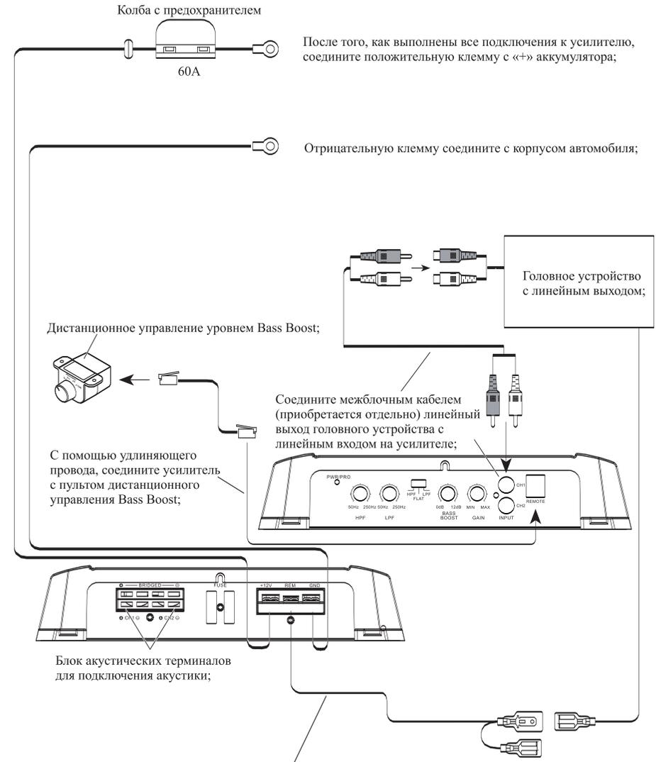
Провод управления включения усилителя. Соедините эту клемму с соответствующим проводом на головном устройстве. Также клемму можно подключить к резистору автомобильной антенны. Еще один метод – подключить провод REMOTE на зажигание автомобиля;
