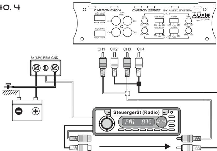
Die **CARBON SERIES** Verstärker besitzen RCA-Eingänge, welche durch Cinchkabel mit den Vorverstärker-Ausgängen des Steuergerätes verbunden werden. Wenn dies nicht möglich ist (meist bei einem Originalradio, OEM) können die Lautsprecherausgänge des Autoradios direkt auf die High-Input-Eingänge des Verstärkers angeschlossen werden.
