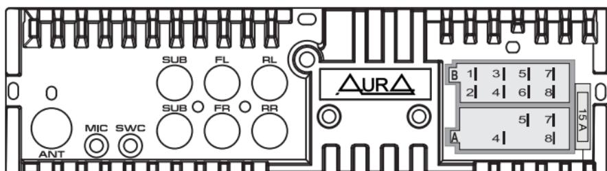
**ANT** - вход подключения антенны радиоприемника
