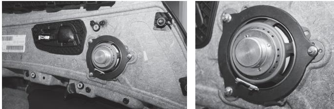
Den medföljande diskanten (RC25) passar direkt i originaluttaget i A-stolpens uttag för diskant, men bör fästas med lite extra smältlim för att inte lossa.
