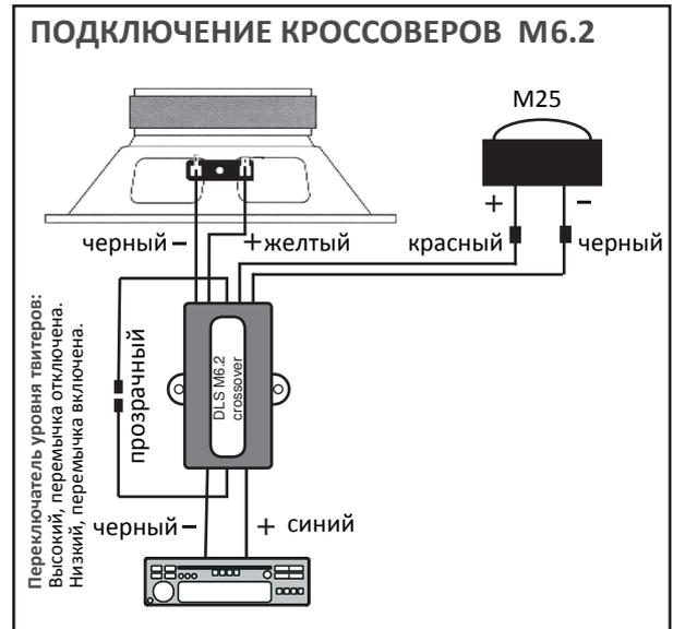
Использование фильтров обязательно. Если вы подключите акустическую систему без фильтров, то звучание системы ухудшится, а динамик может быть повреждён.
