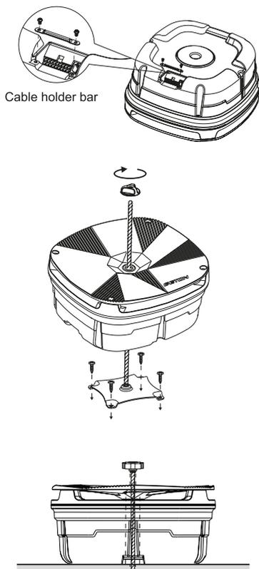
Sichern Sie den Subwoofer mit der mitgelieferten Montageschraube & ggf. Halterings an der bestehenden Ersatzradhalterung Ihres Fahrzeuges. Gehen Sie sicher, dass der Subwoofer ordentlich verschraubt und gesichert ist. Über die kabelgebundene Fernbedienung kann der Subwoofer eingestellt werden, bzw. nutzen Sie den mitgelieferten Kurzschluss-Stecker um die Fernbedienung zu deaktivieren und steuern Sie Ihren Subwoofer mittels Ihrer Headunit.
