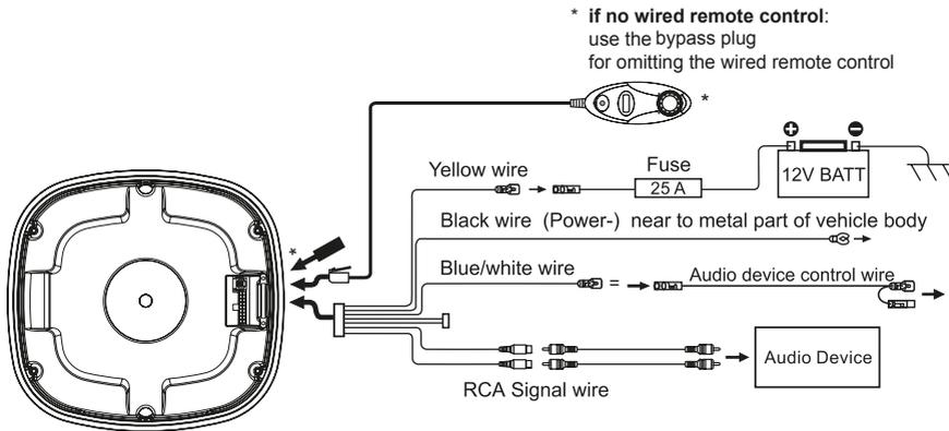
Zum Anschluss des RES 12 über die Cinch (RCA) Anschlüsse, verbinden Sie das blaue Remotekabel mit der Radioeinheit Ihres Fahrzeuges und schließen Sie die Cinchkabel an. Über die Remoteleitung wird der Subwoofer aktiviert.
