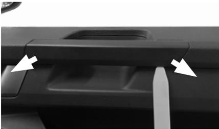
Lösen Sie die sich darunter befindlichen Torx-Schrauben. Eine weitere befindet sich neben dem Lautsprechergitter (siehe Pfeil) und drehen Sie mit einem 10er Maulschlüssel die untere Verriegelung auf 12 Uhr.
