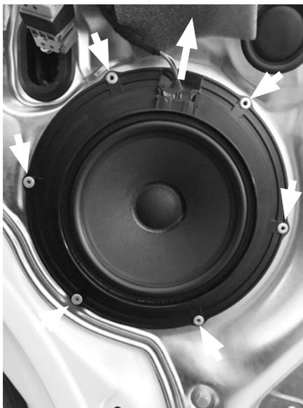
Montieren Sie nach dem Einbau des Tieftonlautsprechers die bei VW separat erhältliche Gummischallführung um eine optimale Ankopplung an die Türverkleidung zu erreichen.
