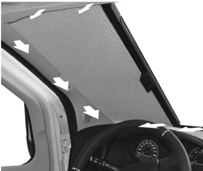
Bei vielen Modellen, kann durch einfaches Entfernen des Türdichtung Gummis und Lösen der Laufschiene des Sonnenrollos genügend Spielraum geschaffen werden, um die A-Säule im unteren Bereich hervorzuziehen.
