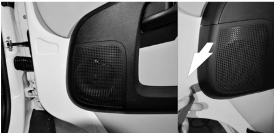
Lösen Sie die Steckverbindung am Originallautsprecher und drehen Sie die drei Torx TX30 Schrauben heraus.
