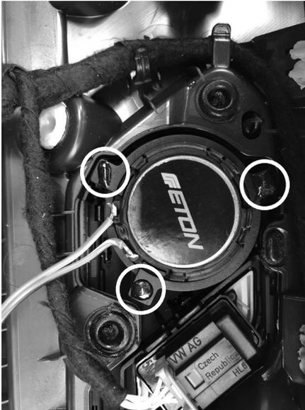
Entfernen Sie mit einem scharfen Messer die drei Schmelzpunkte der Hochtönerfestigung. Stecken Sie den Hochtönerlautsprecher auf die Stifte der Lautsprecheröffnung. Achten Sie darauf, dass alle Klipse korrekt eingerastet sind.
