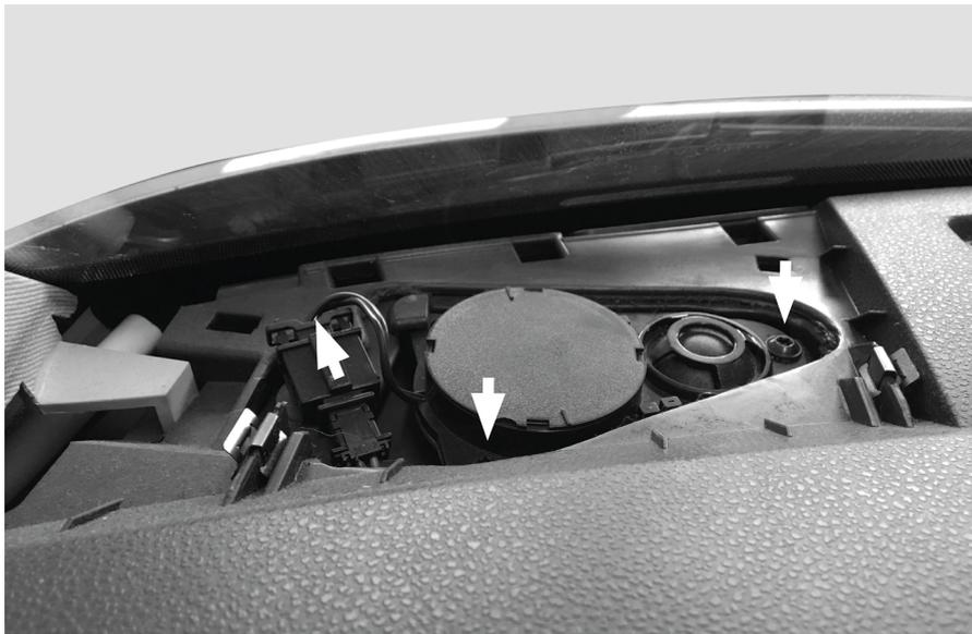
Entfernen Sie die linke und rechte seitliche Abdeckung des Armaturenbretts, hier ist der spätere Einbauplatz für die Frequenzweiche.
