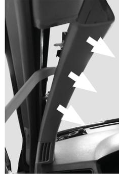
Verlegen Sie die Zuleitung der Frequenzweichen zur Buchse des Serienlautsprecherkabels im Armaturenbrett-Einbauplatz und stecken Sie den Stecker ein.
