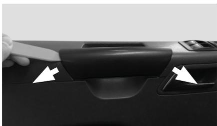
Lösen Sie die sich darunter befindlichen Torx-Schrauben. Weitere befinden sich neben dem Lautsprechergitter (siehe Pfeil) und an der Unterseite der Türverkleidung
