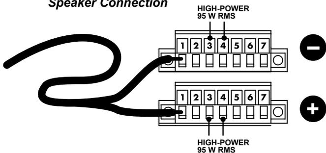
**ACHTUNG:** Der STEALTH 7.1 DSP verfügt über eine asymmetrische Leistungsverteilung. Dies ermöglicht eine optimale Verteilung der Verstärkerleistung auf die einzelnen Kanäle. Daher beachten Sie beim Anschluss der Lautsprecher die sinnvolle Nutzung der asymmetrischen Aufteilung, Kanal 3/4 sind Highpower Anschlüsse und verfügen über mehr Leistung, daher empfiehlt es sich, auf diese Kanäle Tief-Mitteltöner zu klemmen!
