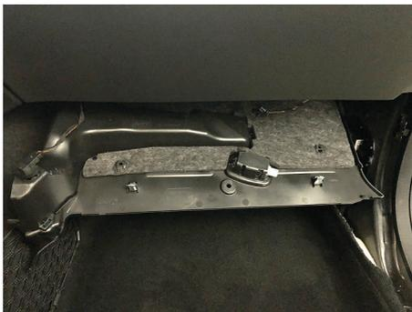
Anschließend ziehen Sie je nach Seite und Modell vorhandene Leitungen aus Ihren Steckverbindern und nehmen Sie die Verkleidung aus dem Fahrzeug. Gehen Sie behutsam vor um nichts zu beschädigen.
