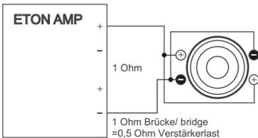
Bei Auswahl des passenden Verstärkers (AMPs) oder Subwoofer darf die Verstärker-Ausgangsimpedanz (Ohm) nicht unterschritten werden!
