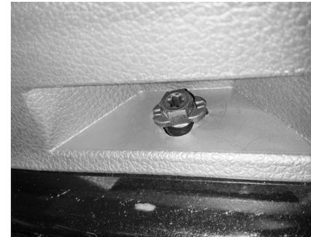
Das nächste Bild zeigt die Lage der Türklinke. An den durch einen Kreis markierten Stellen ist die Türverkleidung mit Klips befestigt.
