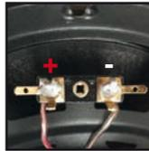
**Achten Sie darauf, dass alle Komponenten phasenrichtig angeschlossen sind, d.h. Plus zu Plus und Minus zu Minus. Die Plusleitung des Lautsprechersystems ist durch einen roten Streifen gekennzeichnet.**
