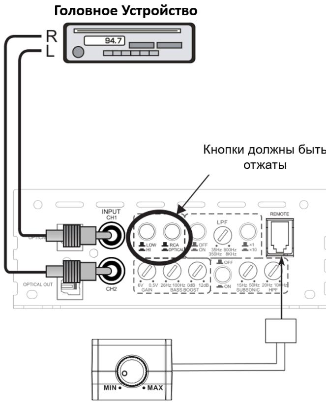
В усилителе применяется балансный вход для подключения источника сигнала. Для минимизации внешних помех необходимо, чтобы источник сигнала и подключаемое устройство имели общий минусовой провод, то есть были электрически заземлены по отрицательной шине. Это обеспечивает согласованную работу компонентов и снижает уровень шумов в аудиосигнале.
