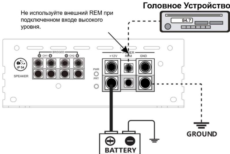
**+12V:** для стабильной и безопасной работы усилителя необходимо использовать провод, сечение которого рассчитано на максимальный ток потребления усилителя, не менее 150А.
