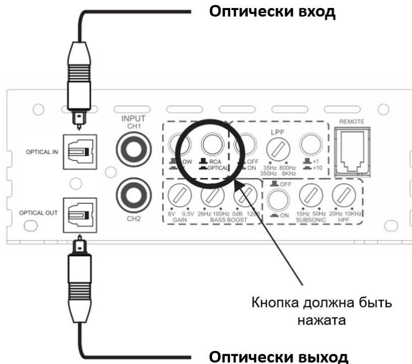
Оптический вход и выход позволяет подключать его к другим устройствам с помощью оптического кабеля. Тип приёма и передачи сигнала — PCM (Pulse-Code Modulation) с частотой дискретизации до 24 бит/192 кГц. Это означает, что сигнал будет передаваться с высоким качеством звука.
