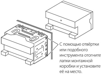
С помощью отвёртки или подобного инструмента отогните лапки монтажной коробки и установите её на место.
