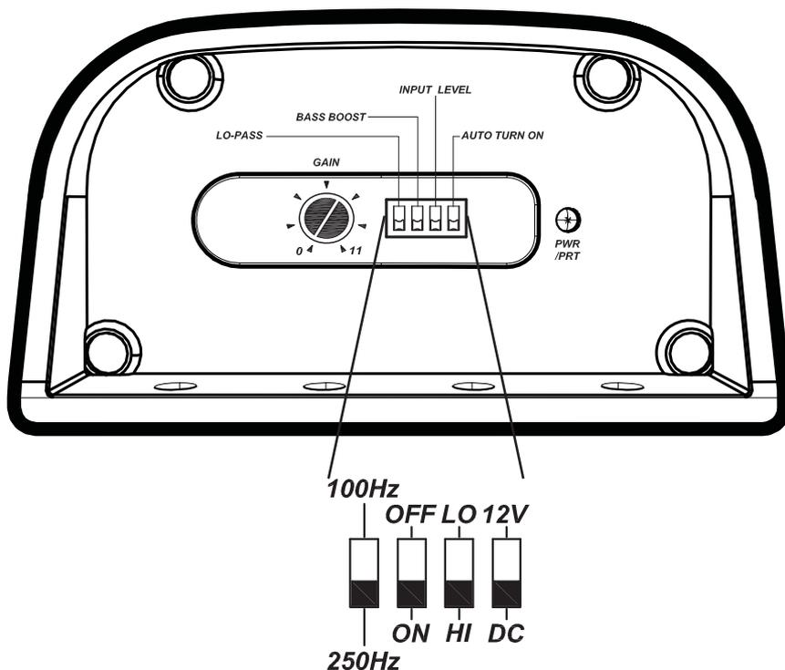
**Sélection de la mise en marche automatique :** La série PX offre deux modes de mise en marche automatique pouvant être sélectionnés au niveau du panneau de connexion, commutateur sur +12 V ou DC offset (décalage en continu). Le mode DC offset entraîne la délivrance d'un signal +12V au niveau du connecteur REM pour l'activation d'amplificateurs supplémentaires.
