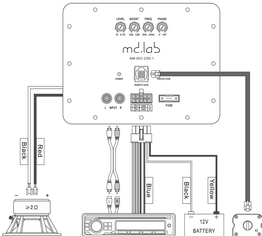
Подключение к высоковольтным выходам источника сигнала:
