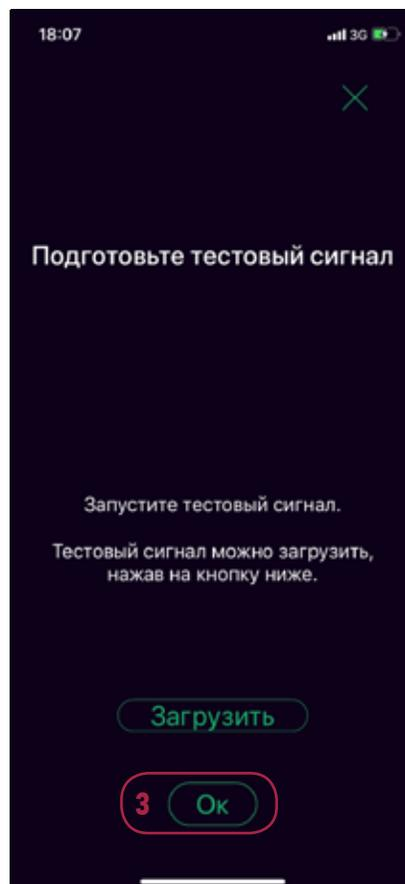
3. Нажмите «Ок», чтобы начать воспроизведение тестового сигнала на автомобильной аудиосистеме. Еще раз нажмите «Ок», чтобы начать калибровку. Убедитесь, что микрофон Вашего смартфона расположен в предполагаемом районе нахождения головы слушателя (водителя).
