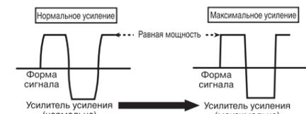
Если при высоком уровне громкости, даже когда коэффициент усиления увеличен, происходит искажение формы сигнала, выходная мощность увеличивается незначительно.
