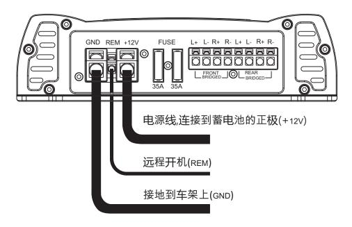
电源线与接地线请用8AWG电缆
